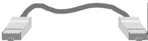
Câble « paire croisée » à utiliser pour du 10 Base-T avec des connecteurs RJ-45
